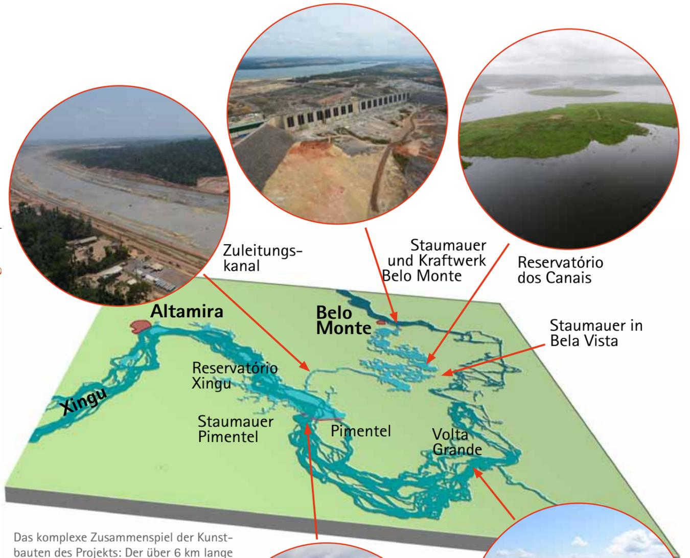
Das komplexe Zusammenspiel der Kunstbauten des Projekts: Der über 6 km lange Damm bei der Insel Pimentel staut den Xingu auf und lässt nur noch 20 % des Wasservolumens über die Volta Grande abfließen. Der Großteil der Wassermassen ergießt sich in den künstlich angelegten Kanal und flutet ein Tal, das sich bis Belo Monte erstreckt. Hier befindet sich das eigentliche Kraftwerk
