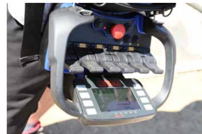
Mit der V7-Fernsteuerung hat Kranführer Siegmar Hude die aktuelle Auslastung des F545 stets im Blick
