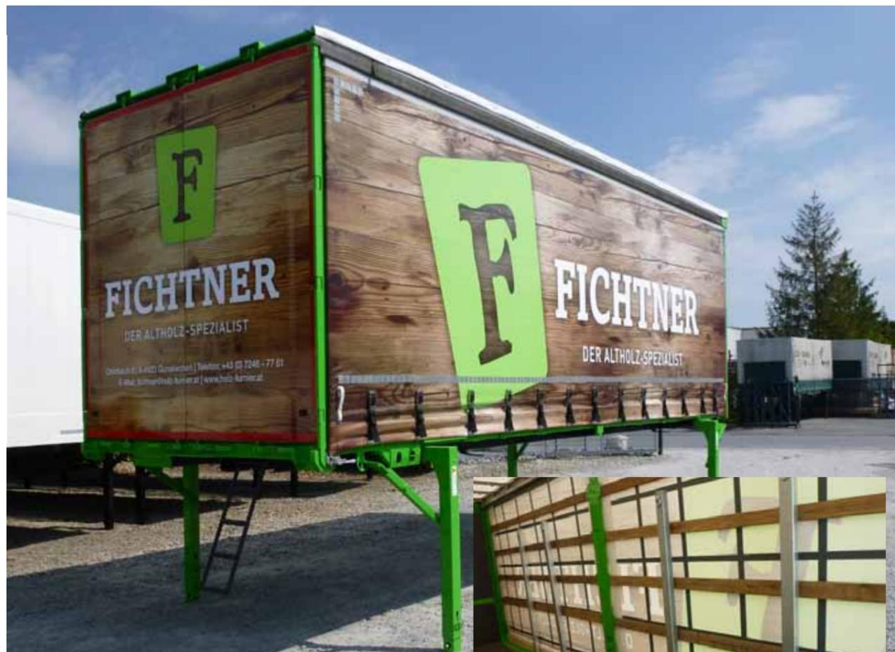
Wer käme hier auf die Idee, dass diese Wechselbrücke gebraucht sein könnte? Mir zusätzlichen Rungen und Gardinendach versehen, erhielt dies Aufbau eine neue Lackierung und kunstvoll bedruckte Planen
