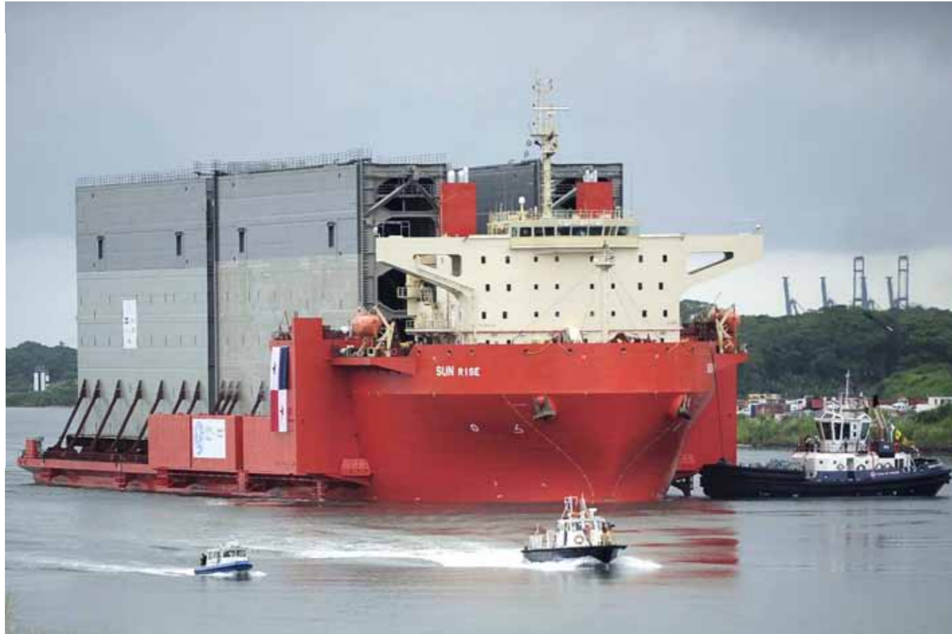
Per Schiff über den Atlantik gebracht: Die in Italien gebauten, monströsen Tore der neuen Schleusen. Sie sind knapp 60 Meter breit, zwischen 30 und 40 Meter hoch und rund 10 Meter dick.
