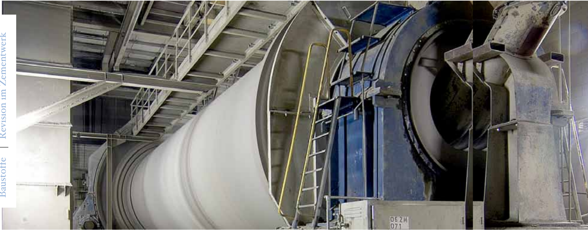
Die Krupp-Zweikammer-Rohrmühle läuft mit 16 Umdrehungen in der Minute und wird von zwei 1.350 kW starken Motoren angetrieben
