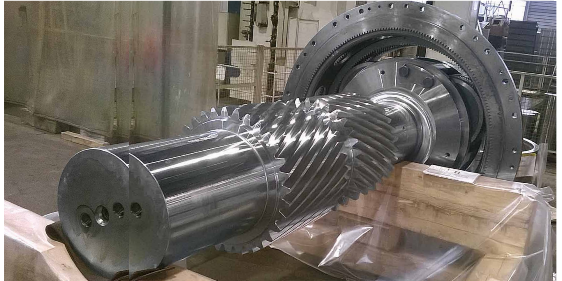
Die fertig vormontierten neuen Pfeilritzeln mit den alten Planeten-Eingangsstufen
