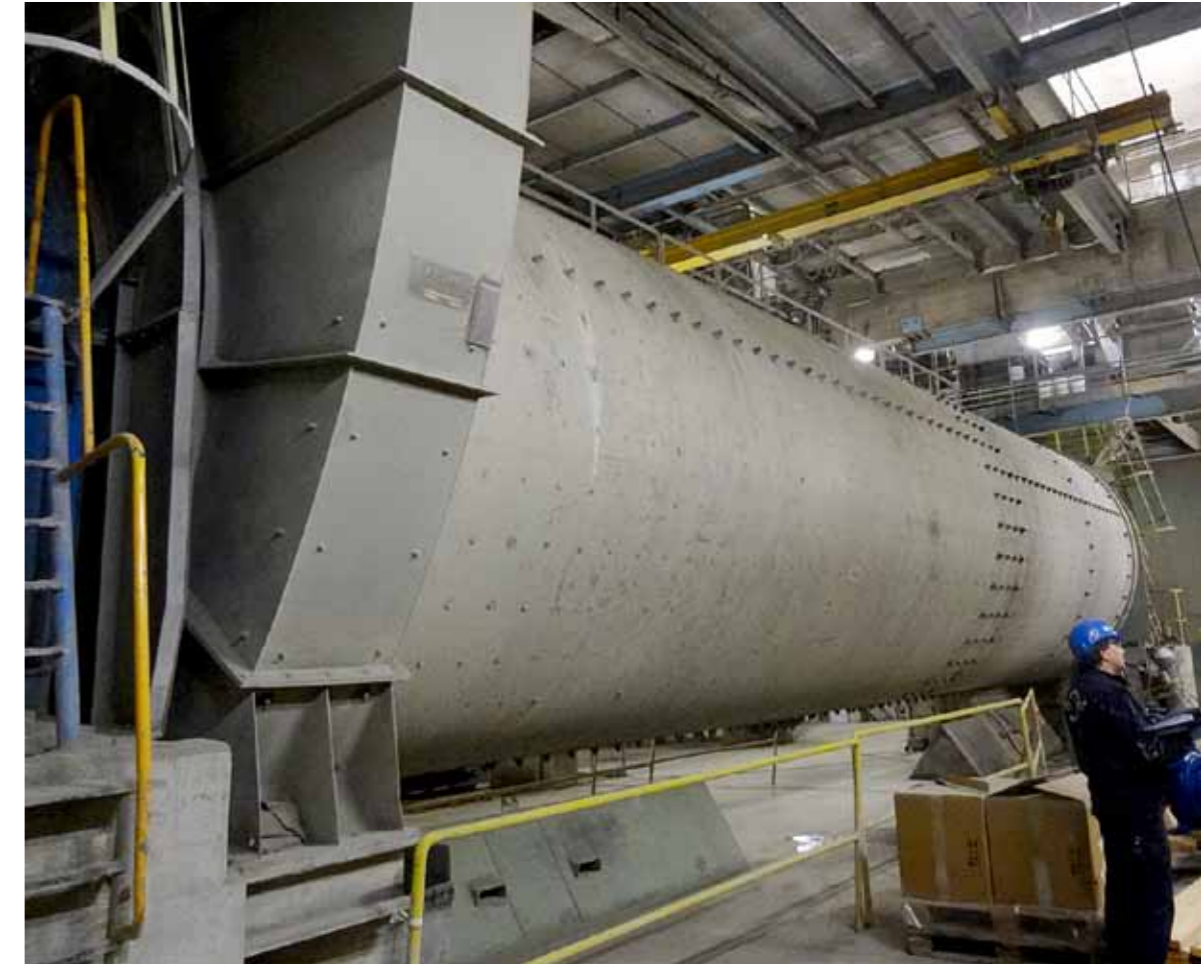
Die Krupp-Zweikammer-Rohrmühle läuft mit 16 Umdrehungen in der Minute und wird von zwei 1.350 kW starken Motoren angetrieben
